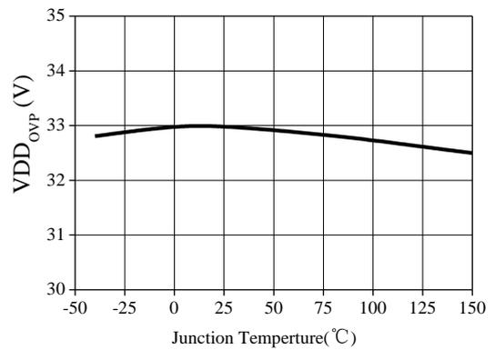
(f) VDD<sub>OVP</sub> VS T<sub>j</sub>
